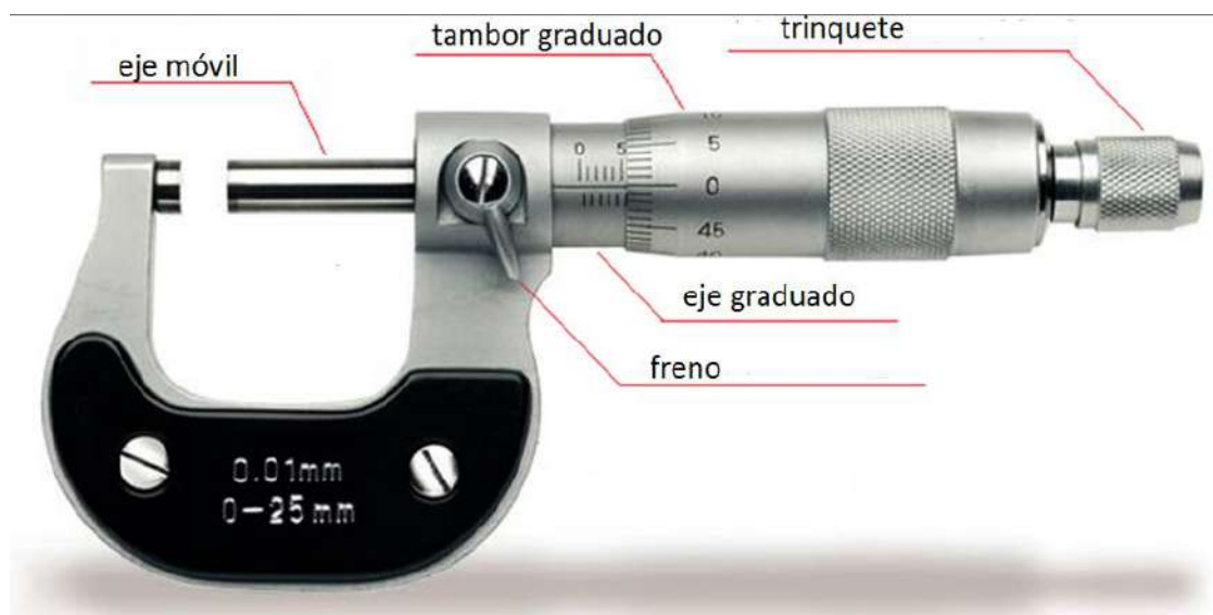
Fig.5.2: Esquema de partes de un micrómetro
